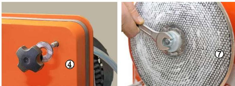
Если после замены диска на модели обнаружены борозды – провести правку поверхности диска металлической пластиною из нержавеющей или инструментальной стали толщиной не менее 1 мм. Общее время правки зависит от состояния поверхности, но не должно превышать 10 сек между повторами, с последующей проверкой результата на гипсовой модели.
