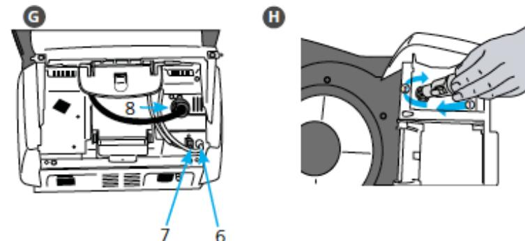
H) Вставьте штекер нагревателя в соответствующий разъем. Закрепите штекер нагревателя, повернув его на 45°.
