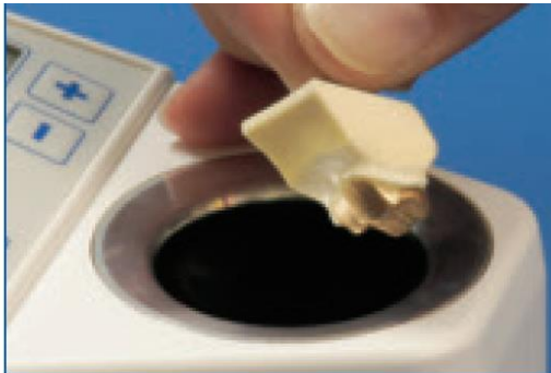
Рисунок № 2 Этап 2: подготовка к погружению штампа
