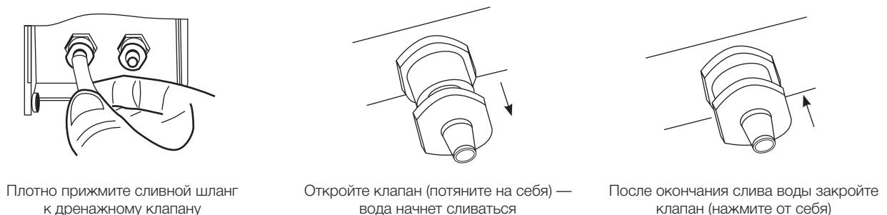
Рис. 5. Порядок слива использованной воды из бака стерилизатора
