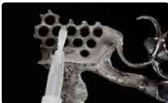
Непосредственно после пескоструйной обработки нанести SR Link одноразовой кисточкой и оставить на 3 мин.
