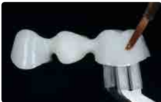
Непосредственно после пескоструйной обработки нанести SR Link...
