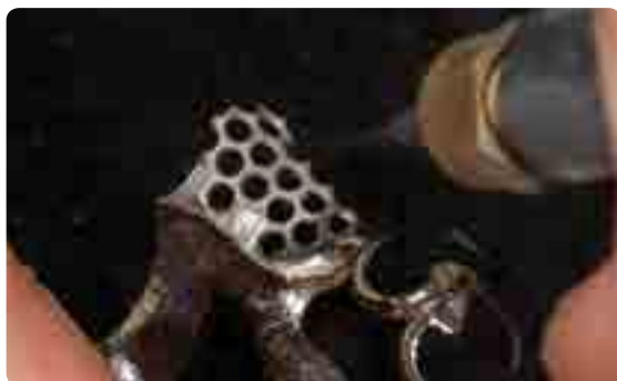
Провести тщательную пескоструйную обработку ретенций с Al_2O_3 (80–100 мкм) и под давлением 3 бара, остатки песка стряхнуть с каркаса постукивая по нему инструментом.
