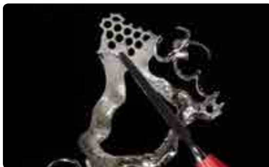
Провести тщательную пескоструйную обработку ретенций с Al_2O_3 (80–100 мкм) и под давлением 3 бара, остатки песка стряхнуть с каркаса постукивая по нему инструментом.
