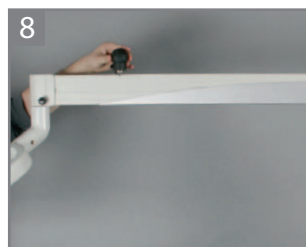
8 Ослабьте стопор для фиксации положения по вертикали.
