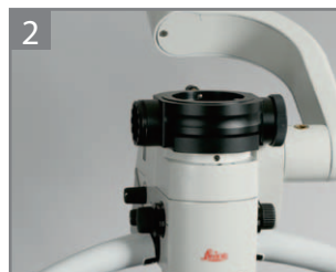
2 Установите светоделитель. Для наблюдения 50%/50% или 70%/30%.
