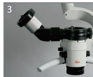
3 Установите стереонасадку для второго наблюдателя с левой стороны.
