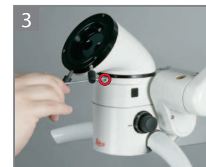
3 Затяните зажимной винт.
